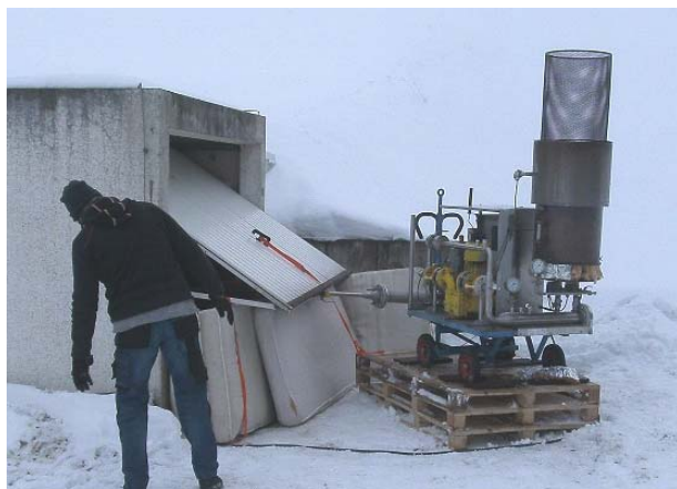
Abbildung 3, Bilder aus der Bestandsaufnahme; Dep. Himmelsfürst und Wittgensdorf [DAS - IB GmbH], li. Oben Emissionsbegehung mittels Laser und HS 680 auf der Deponie Himmelsfürst / re oben Auswertungen Deponie Wittgensdorf / li unten; IBN der mobilen Kleinstfackel auf der Deponie Himmelsfürst / re unten; Betrieb der mobilen Kleinstfackel auf der Deponie Wittgensdorf
