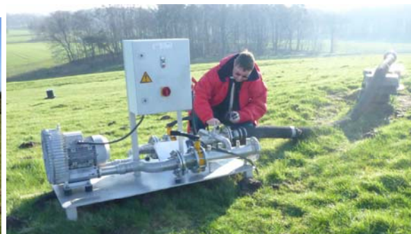
Abbildungen 2, Einsatz der mobilen Kleinstfackel DMF V mit mobiler Gasanalyse und Durchflußmessung auf dem Standort in Vechta - Tonnenmoor [DAS - IB GmbH] als Ersatz für die ursprüngliche Gasentsorgung in der Ziegelei sowie theoretische und praktische Lufteinblasung (Bild oben rechts und unten)
