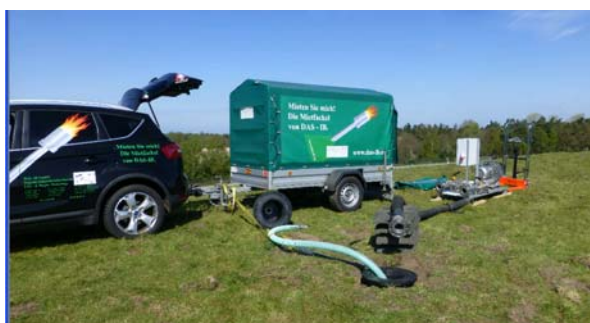
Abbildungen 2, Einsatz der mobilen Kleinstfackel DMF V mit mobiler Gasanalyse und Durchflußmessung auf dem Standort in Vechta - Tonnenmoor [DAS - IB GmbH] als Ersatz für die ursprüngliche Gasentsorgung in der Ziegelei sowie theoretische und praktische Lufteinblasung (Bild oben rechts und unten)
